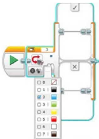
Figura 5 – Bloco comutação do software LEGO® MINDSPORMS® Education EV3 e a configuração do sensor de cor. Fonte: Autoria própria.
